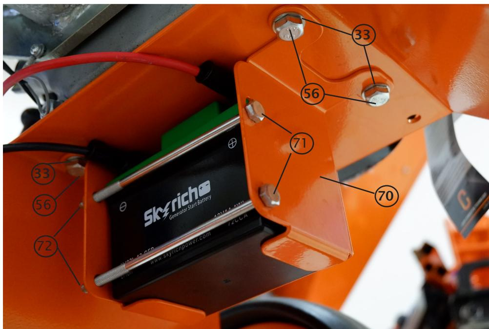
Schließen Sie die Batterieleitungen an die Klemmen der Batterie an (rot an positiv(+)).
